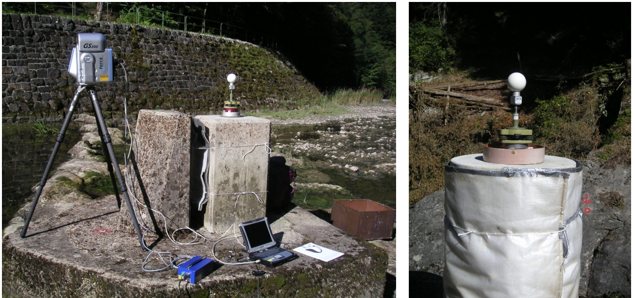
Abb. 30/31: Laserscanner Trimble/Menzi GS200 (links) mit Messkugel auf Referenzpunkt (rechts) anlässlich von Testmessungen 2004 an der Staumauer «In den Schlagen» am Sihlsee (swisstopo 2004)
