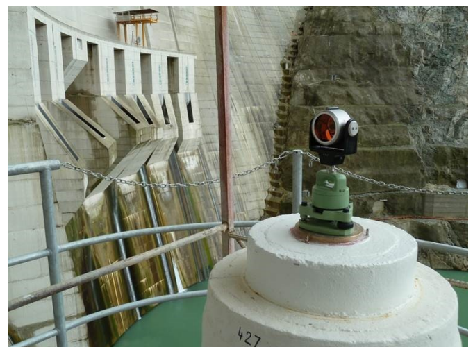
Abb. 63/64: Totalstation Leica TDA5005 (links) und Leica Präzisionsreflektor (rechts) je auf doppelwandigen Vermessungspfählen auf Balkonen der Staumauer «Deriner», Türkei (Pöry Schweiz AG)
