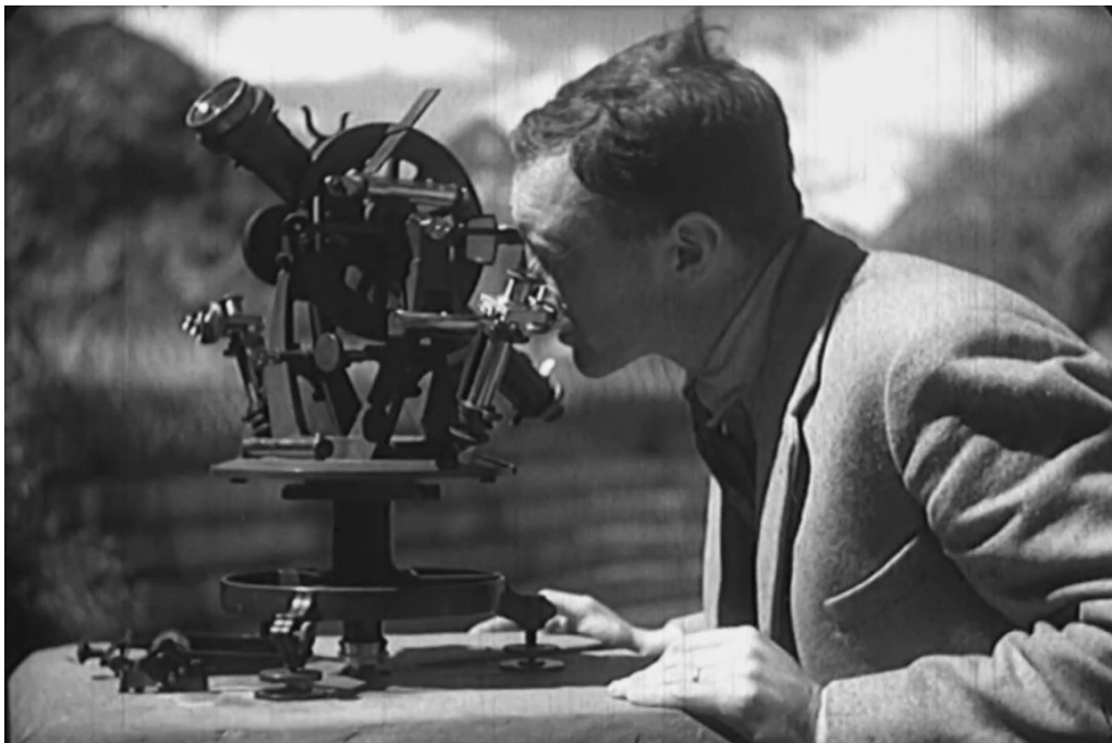
Abb. 11: Geodät (vermutlich Ing. W. Lang) am Hildebrand Theodolit Nr. 43 der Eidg. Landestopographie bei Messungen während des Baus der «Spitallammsperre». Einzelbild aus dem Film «Bau der Kraftwerke Oberhasli» (1932) (© Kraftwerke Oberhasli AG)
