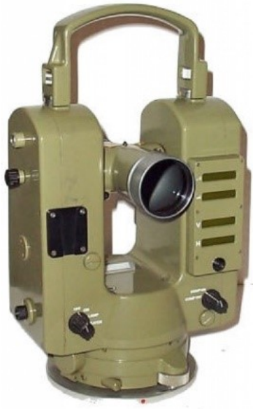
Abb. 57: Elektronischer Theodolit Kern E2 (1984-1988)
