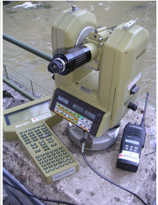
Abb. 68: Wild T3000 mit Wild GPC1 und Funkgerät im Netz «In den Schlägen» (Sihlsee) (swisstopo 2004)
