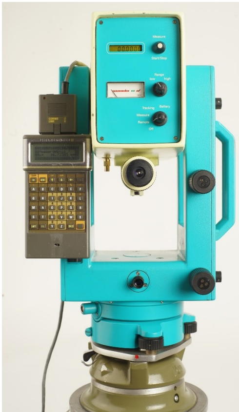
Abb. 71: Kern Mekometer ME5000 mit PSION Organizer II (Pöry Schweiz AG)
