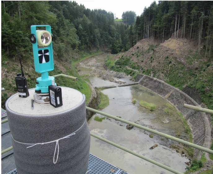
Abb. 55: Reflektor Kern ME5000 mit Funkgerät und Hygro-/Thermo-/Barometer auf der Staumauer «In den Schlagen», Sihlsee (swisstopo 2014)
