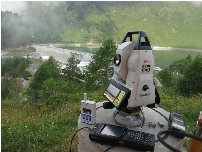
Abb. 69: Leica TDA5005 mit PSION Teklogix Workabout Pro, Feld Hygro-/Thermo-/Barometer Greisinger GFTB 200 (links) und Funkgerät im Netz «Piora» (Ritomsee) (swisstopo 2014)
