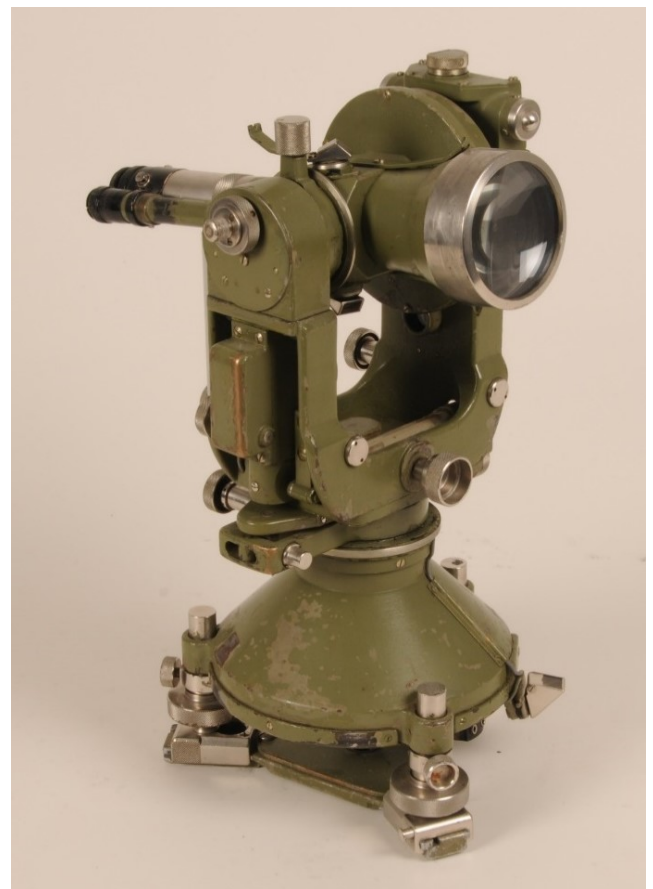
Abb. 20: Universaltheodolit Wild T3 (swisstopo)
