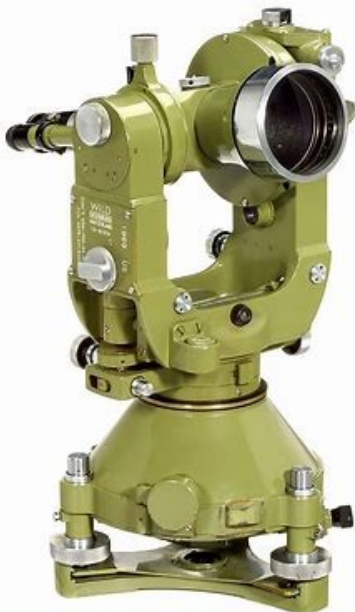
Abb. 36: Präzisions-Triangulationstheodolit Wild T3 (produziert 1925-1988)
