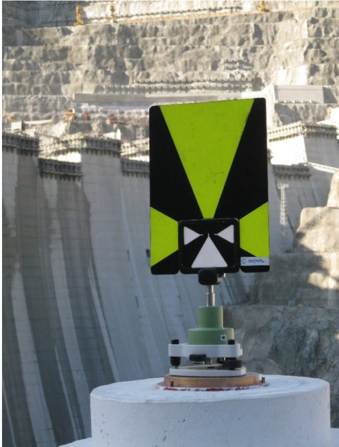
Abb. 42: Wild/Leica Zielmarke mit Fernzieltafel, Staumauer «Deriner», Türkei (Pöry Schweiz AG)
