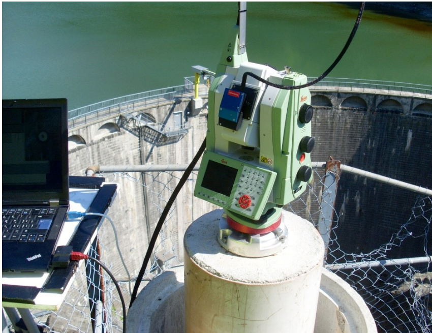
Abb. 73: Leica MS50 mit QDaedalus (2015) auf einem Pfeiler im Netz der Staumauer «Montsalvens» (swisstopo/ETHZ)
