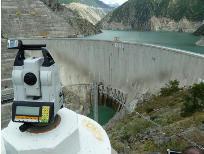
Abb. 61/62: Totalstation Leica TDA5005 (links) und Leica Reflektor mit Zieltafel (rechts, anlässlich des Baus) auf Vermessungspfählen bzw. Steckbolzen der Staumauer «Deriner», Türkei (Pöry Schweiz AG)
