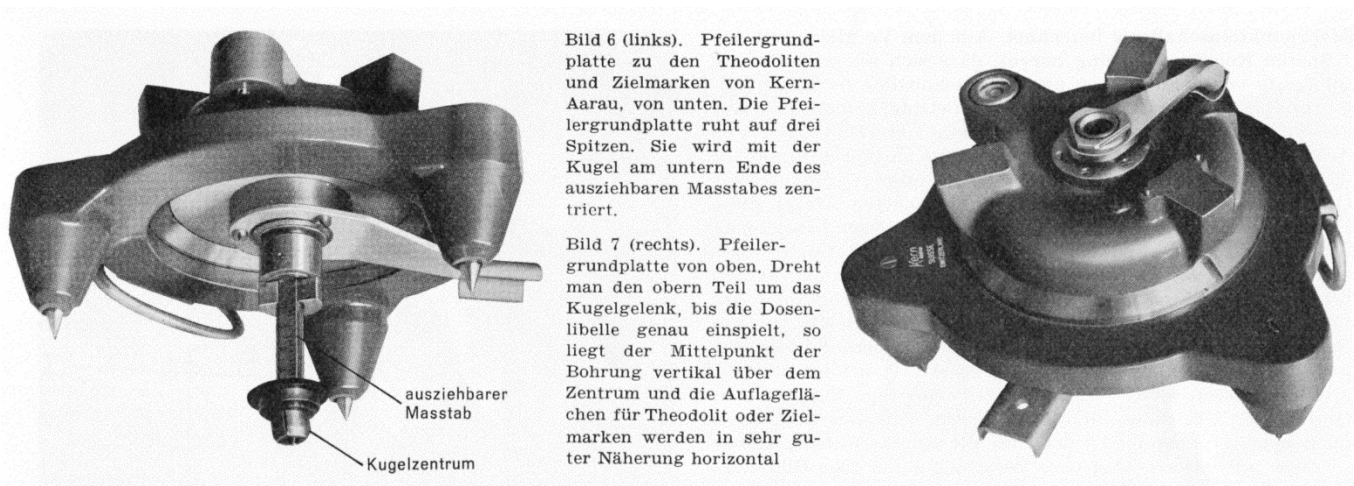
Abb. 22: Kern Pfeilergrundplatte (Kobold 1958)
