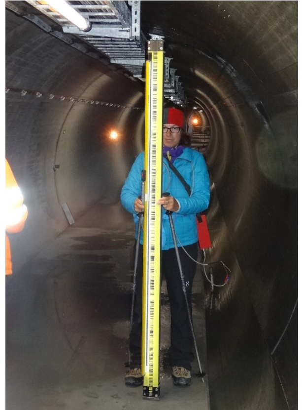
Abb. 47: Digital-Nivelliermire Leica im Kontrollgang der Staumauer «Muttsee» (Axpo Power AG)
