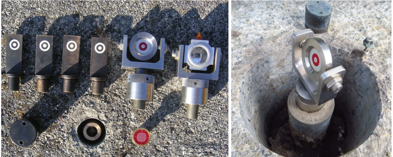
Abb. 38/39: Steckmiren, Zentrierzapfen, Kleinzielmarke und Kleinreflektor für den Einsatz in Kappenbolzen (links); Kleinzielmarke eingesetzt im Netz der Staumauer «In den Schlagen», Sihlsee (rechts); vgl. auch Abb. 16 (Bilder swisstopo)
