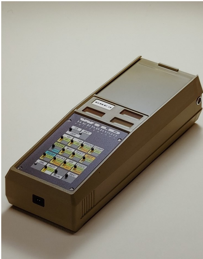
Abb. 67: Datenterminal Wild GRE3 mit Magnetblasenspeicher (1983) (Leica Geosystems AG)
