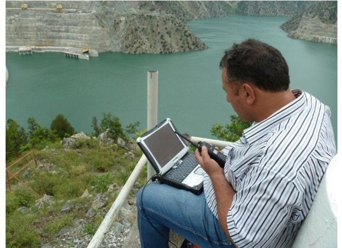
Abb. 70: Panasonic CF-18 mit Satz- und Distanzmessprogramm im Netz der Staumauer «Deriner», Türkei (Pöry Schweiz AG 2013)
