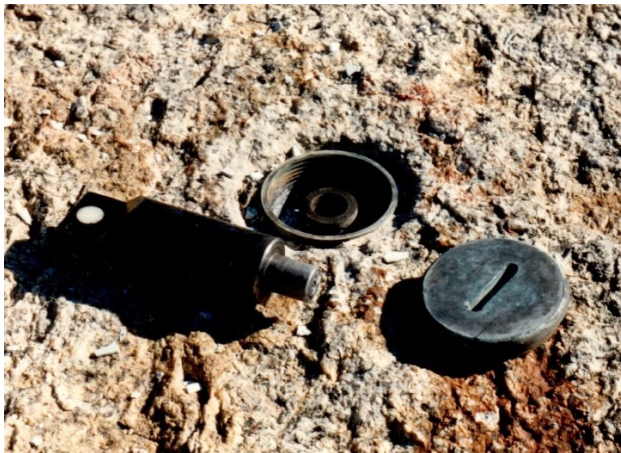
Abb. 40: Zentrumsbolzen im Fels mit Schutzring und Schutzdeckel sowie Kleinzielmarke (Schneider Ingenieure AG)
