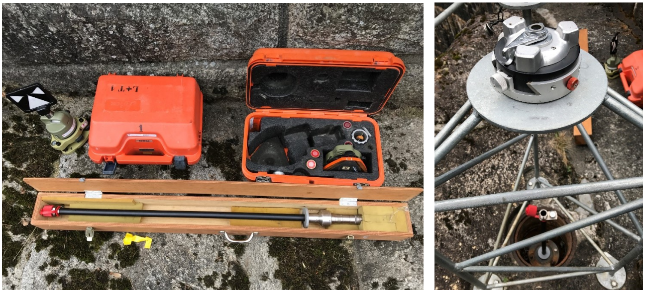
Abb. 25/26: Zentrierstab für optische Präzisionslotungen (links in der Holzkiste und rechts eingesetzt im Messrohr) zur Kombination mit geotechnischen Messungen wie Gleitmikrometer/TRIVEC (1994); Rechts: Stahlpfeiler mit Kreuzschlitten zur optischen Lotung mit Nadirlot über der Messmarke im Zentrierstab. Einsatz im Netz der Staumauer «Pfaffensprung» (swisstopo 2017)
