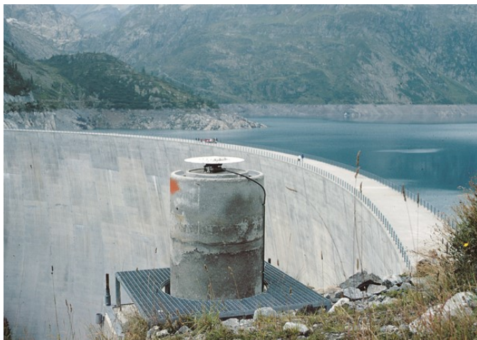
Abb. 75: GPS-Antenne Trimble 4000SSi Staumauer «Emosson» (swisstopo 1996)
