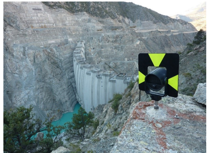
Abb. 61/62: Totalstation Leica TDA5005 (links) und Leica Reflektor mit Zieltafel (rechts, anlässlich des Baus) auf Vermessungspfählen bzw. Steckbolzen der Staumauer «Deriner», Türkei (Pöry Schweiz AG)
