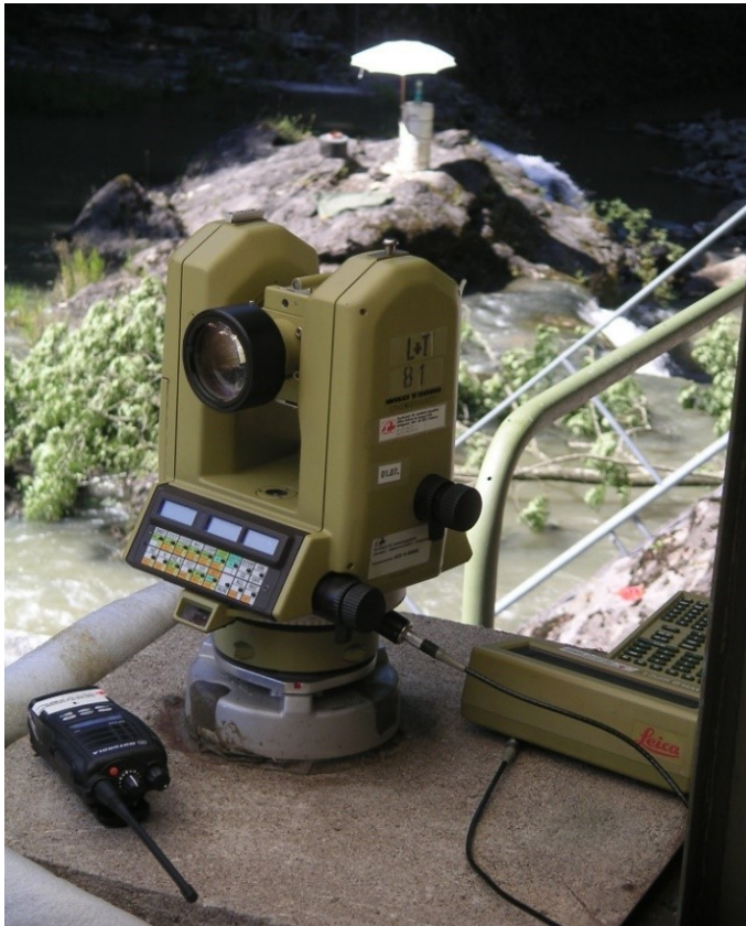
Abb. 59: Wild T3000, elektronischer Präzisions-Theodolit mit panfokalem Hochleistungs-Fernrohr, Staumauer «In den Schlägen» (Sihlsee) (swisstopo 2004)
