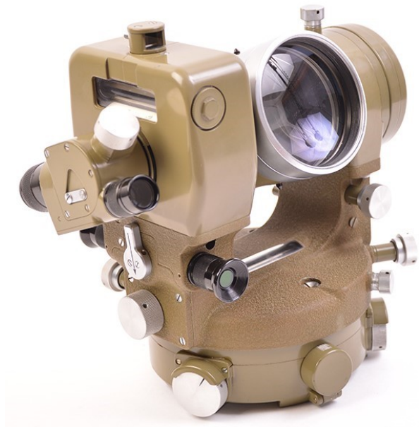
Abb. 37: Kern DKM3 mit Spiegellinsen Fernrohr (produziert 1939-1980)
