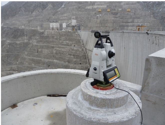
Abb. 63/64: Totalstation Leica TDA5005 (links) und Leica Präzisionsreflektor (rechts) je auf doppelwandigen Vermessungspfählen auf Balkonen der Staumauer «Deriner», Türkei (Pöry Schweiz AG)
