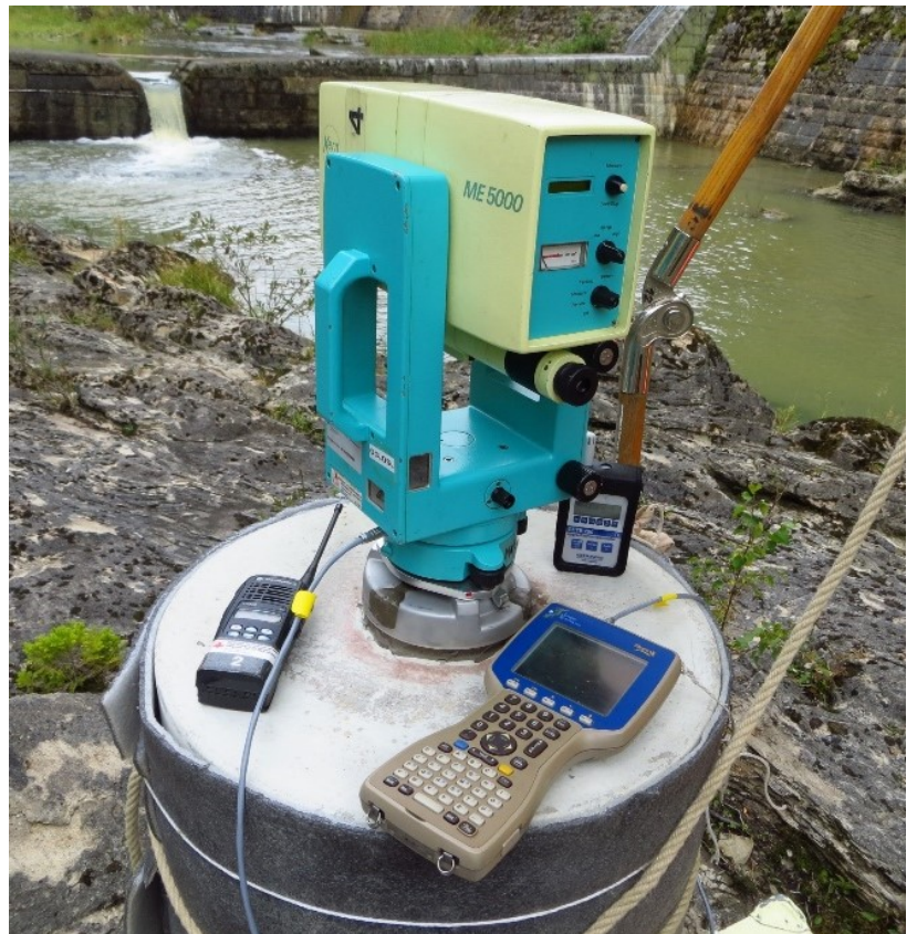
Abb. 72: Kern Mekometer ME5000 mit Allegro CX von Juniper Systems sowie Funkgerät und Feld Hygro-/Thermo-/Barometer Greisinger GFTB 200 (rechts hinten) im Netz «In den Schlägen» (Sihlsee) (swisstopo 2014)
