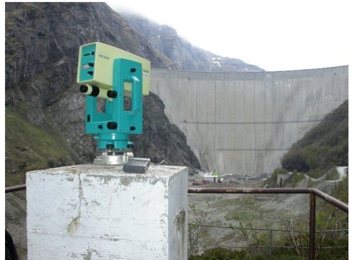
Abb. 54: Kern Mekometer ME5000 (1994) mit Psion, Staumauer «Mauvoisin» (Pöryr Schweiz AG)
