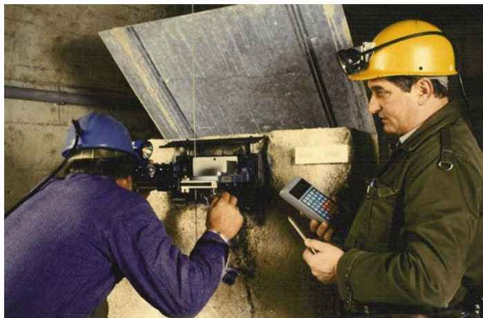
Verformungsmessung am Lot in einem Kontrollgang in einer Bogenmauer (Quelle: Emosson SA)
