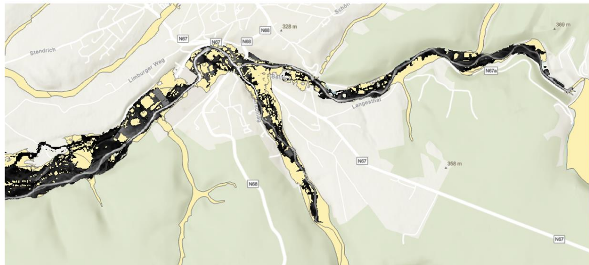
Figure 32 - Superposition à Eupen de l'emprise maximale modélisée (noir) et de la digitalisation DCENN (jaune)
