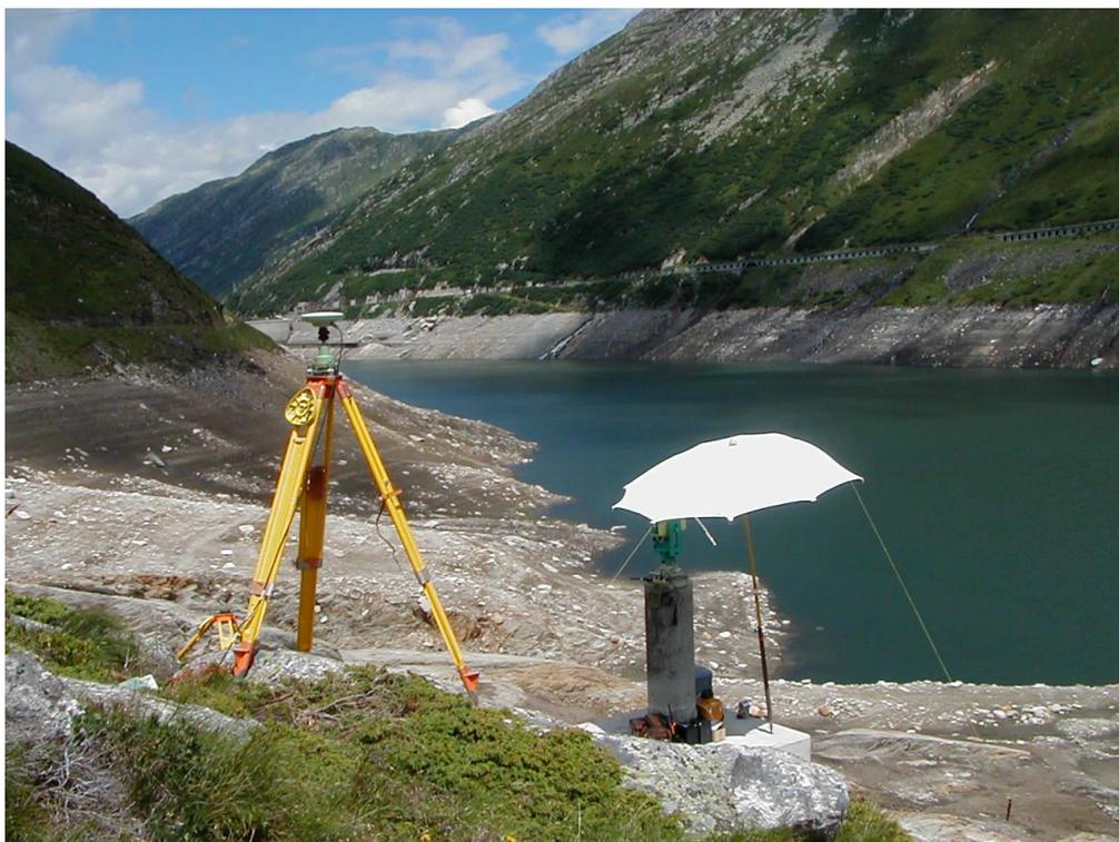
Figure 2-5 : Mesure GNSS en combinaison avec des mesures de précision des distances
