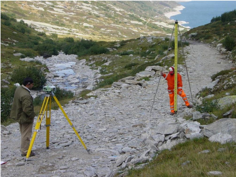
Figure 2-2 : Nivellement de précision à large échelle
