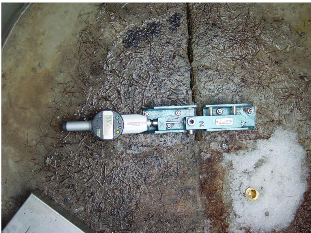
Figure 5-1 : Mesures de jointmètre en combinaison avec mesure géodésique
