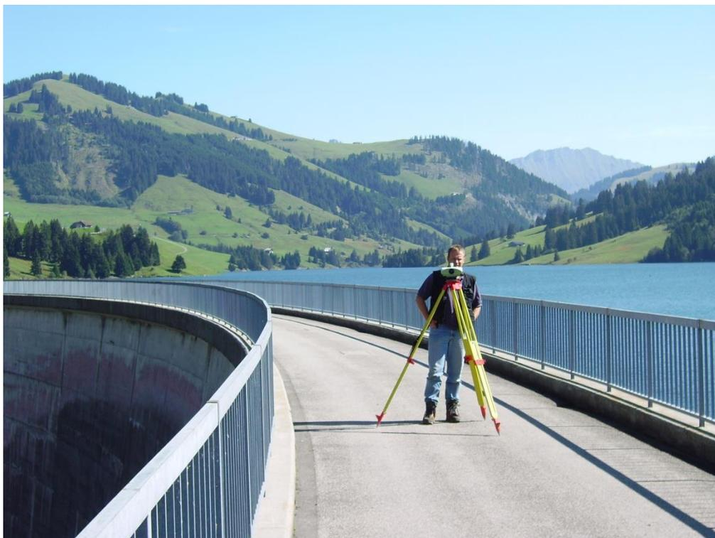
Figure 3-2 : Nivellement de précision sur le couronnement du barrage
