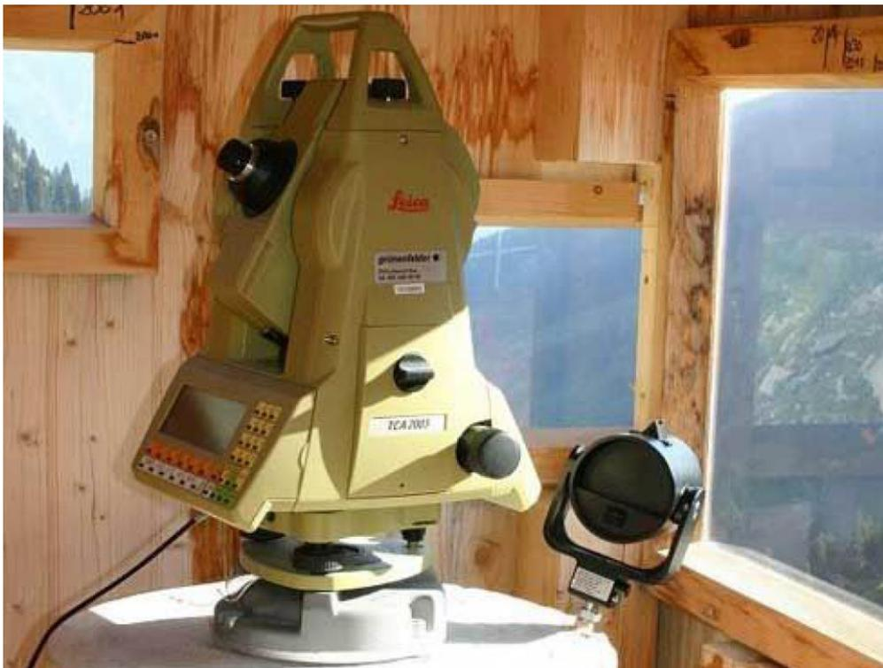
Figure 2-3 : Tachymètre motorisé d'un dispositif de mesure automatique
