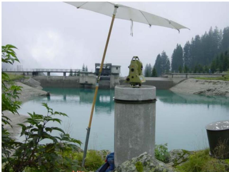
Figure 3-1 : Pilier de mesure à double manteau
