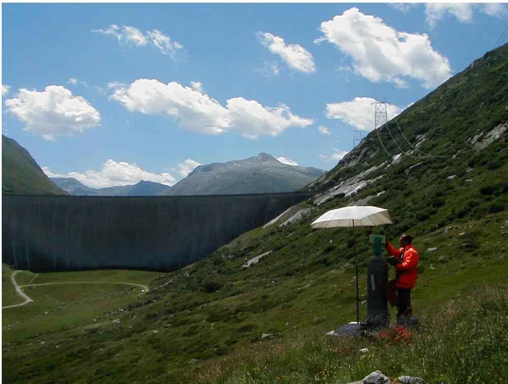
Figure 1-5 : Piliers de mesure du réseau étendu du barrage de Santa Maria
