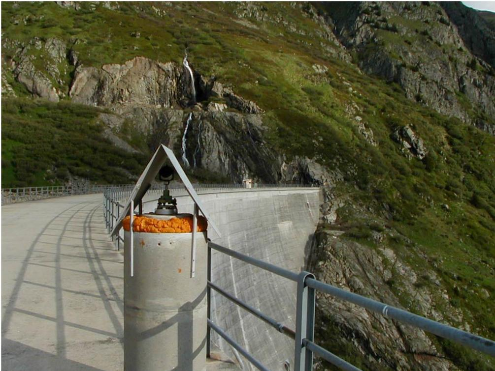
Figure 1-6 : Réseau étendu; dispositif de mesures géodésiques permanent
